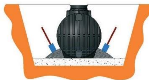
Obrázek: Hutnění prostoru pod nádrží
