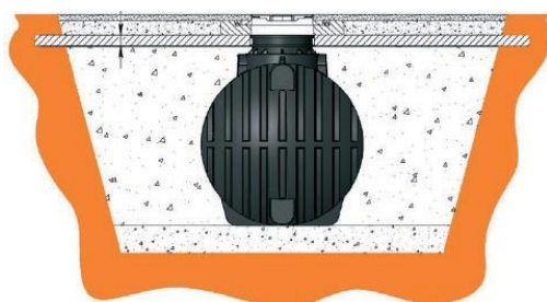
Obrázek: Instalace nádrže v pojízdném terénu
