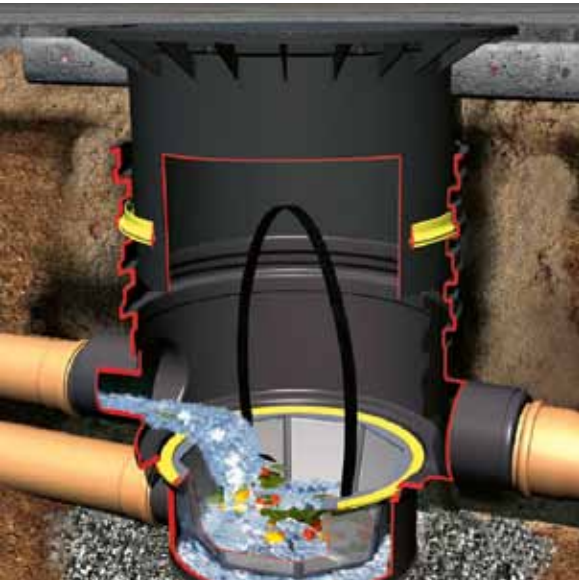
Filtrační koš Comfort do zahradní nádrže, pro odvodňované střešní plochy o velikosti do 300 m 2 ( destovenadrze.cz )
