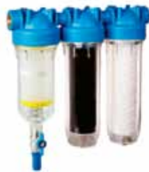
Filtr Atlas Hydra Rainmaster Trio RSH 1" + FA + LA. Třístupňový domovní filtr se třemi nádobami a mechanickým čištěním zvládne čistit jak vodu užitkovou, tak i pitnou. První nádoba s filtrační schopností 50 mikronů filtruje mechanické nečistoty (např. písek) a díky spodnímu ventilu je jednoduše vymývatelná. Nádoba s aktivním uhlím zajišťuje odstranění zápachu, zabarvení a chlórů. Poslední nádoba s filtrační schopností 25 mikronů protékající vodu dočišťuje
