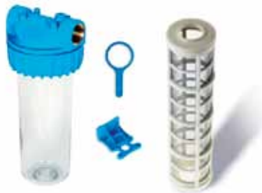
Jemný filtr Dolphin 10" ( destovenadrze.cz ). Kompletní sada filtru s vymývatelnou vložkou, držákem pro uchycení filtru a klíčem na snadné povolení matice při čištění vložky je vyrobena z netoxických materiálů ideálních pro styk s vodou. Vhodná pro průtok vody do 3500 l/h
