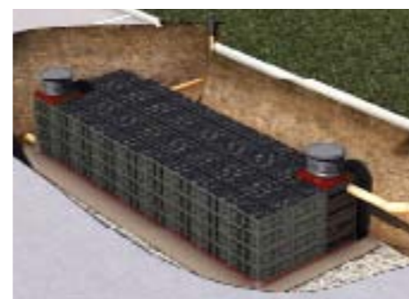
Schema odvodu dešťové vody ze střechy a do vsakovacího systému ecobloc, s odvětrávacím potrubím a dvěma kontrolními šachtami
