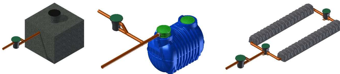
Obrázek 1: Filtrační šachta Aquabin – možnosti instalace, zleva: s betonovou nádrží, s plastovou nádrží, se vsakovacím systémem
